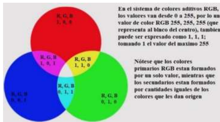
Figura 1.11 Comparación de valores RGB. Medición tipo 255,255,255 y 1,1,1. Imagen propia
