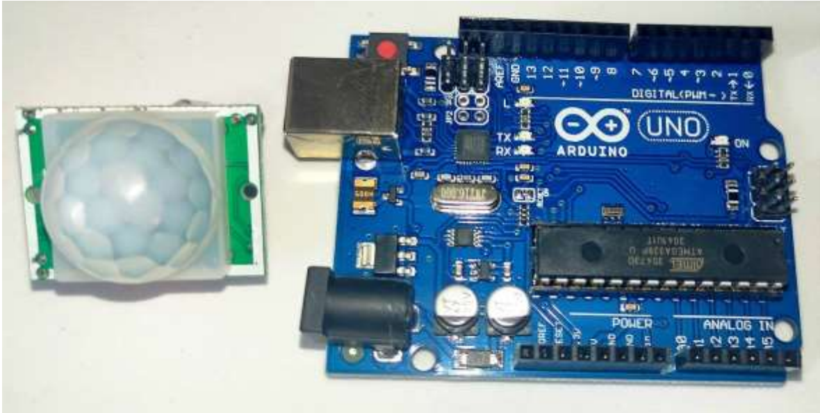
Figura 3.4 Sensor de movimiento PIR y placa Arduino UNO. Imagen propia.
