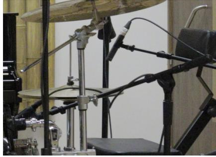
El tom 1 se grabó con micrófono Shure SM27 porque debido a su polaridad cardioide ayuda a minimizar los sonidos de los otros tambores y platillos. Se ubicó en un ángulo de 45 grados sobre el parche con la cápsula del micrófono apuntando al centro, para realzar el ataque y los matices del borde.
