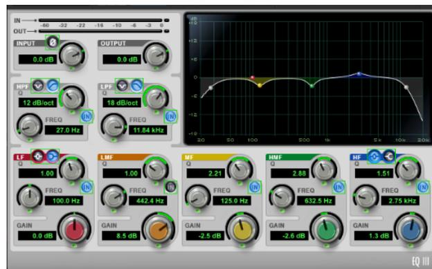
En este proceso se usó el ecualizador lineal para no alterar la respuesta en frecuencia añadiendo armónicos como lo es el ecualizador Fab Filter pro Q3 utilizando un filtro pasa bajos a partir de la frecuencia de 50 Hz y restando 1 dB en la banda de frecuencias medias en 724 hz con una Q de 1.75
