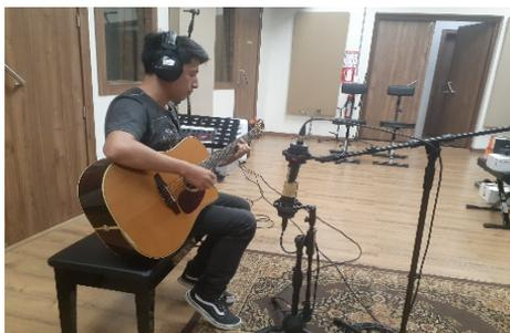
3. El charango se grabó en el estudio B, se utilizaron dos micrófonos AKG C414, con patrón polaridad cardioide, con una distancia aproximadamente 70 cm entre ellos para capturar el sonido en estéreo y así obtener una mayor amplitud.
