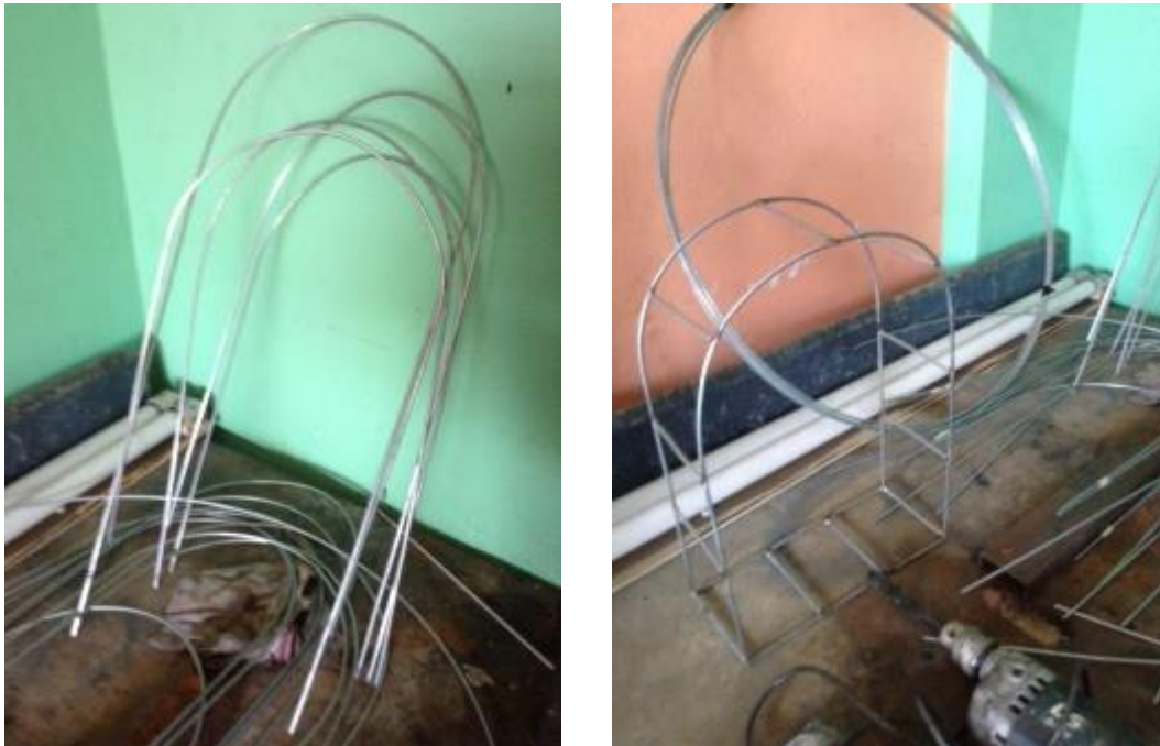
Ilustración 14 formación de los arcos y unidos con soldadura
