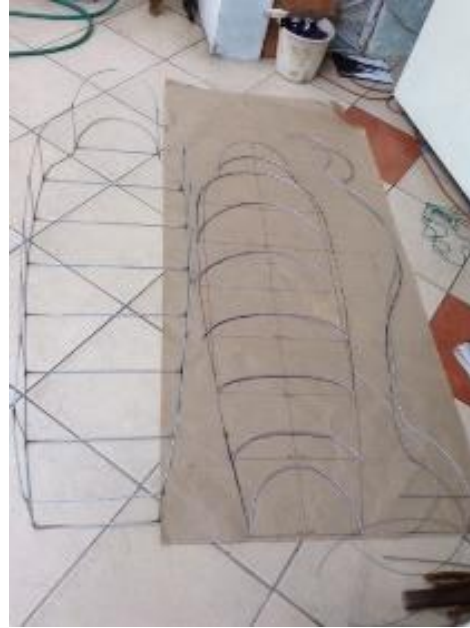
Ilustración 12 estructura de la caja y tapa del sarcófago unidas con soldadura.
