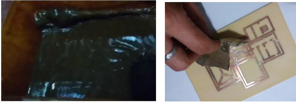
Fig. 64. Proceso elaboración de placas Proceso del ácido y posterior lijado
