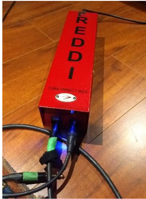
Figura 45 - El bajo conectado a la caja directa de tubos activa REDDI de A Designs.
