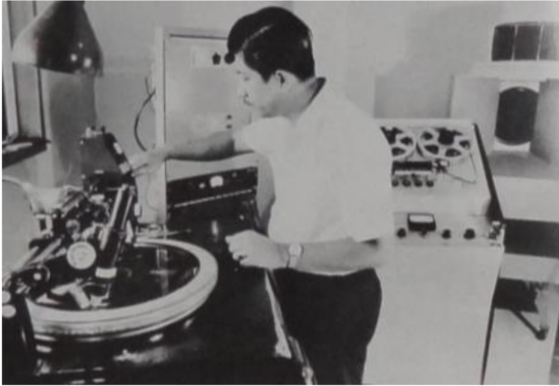
Proceso de grabación de un LP
