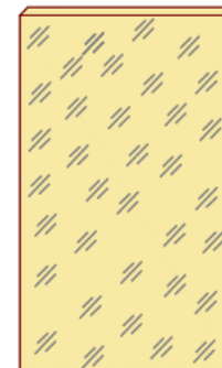
Contrachapado de madera de 6 mm con 80 mm cavidad de aire rellena parcialmente con material absorbente
