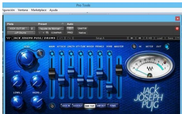
Uno de los tipos de compresores que se usó fue el JJP para el Drum set, permitiéndonos tener control de un parámetro como el gate o puertas de ruido y además de otros parámetros que nos permitirán modificar la señal, ya que como todo compresor lo que busca es controlar las dinámicas de las señales. Este compresor de fábrica viene con un threshold predeterminado.
