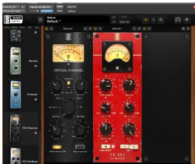
Para las guitarras, bajo y Synth se usó el plug in FG 401 que permite tener un treshhold ajustable con una ratio 4:1.
