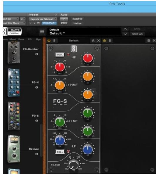
Al usar este tipo de ecualizadores en la cadena de señal lo que se buscó es realizar una ecualización sustractiva, sin alterar la respuesta de frecuencia de la señal grabada, cortando frecuencias no deseadas y posteriormente el uso del ecualizador FG- S para poder resaltar un rango de frecuencias en específicos. Este ecualizador al no ser lineal, resaltará cierto contenido de componentes armónicos. Primordialmente el uso de ambos ecualizadores fueron usados en instrumentos como:
