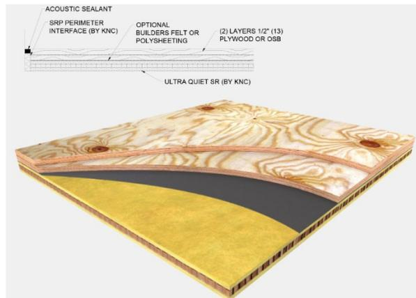
Diseño de piso con ultra quiet sr con cubierta de osb o plywood de media pulgada. <sup>22</sup>
