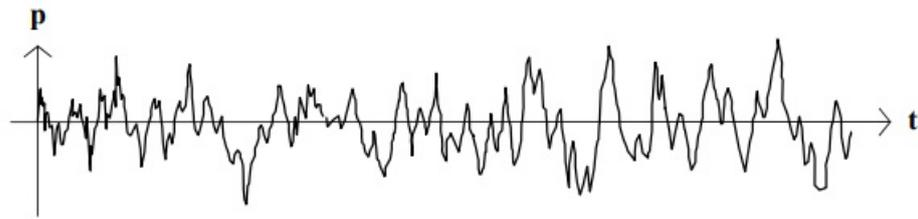
Figura 1. 3 Ejemplo de onda no periódica [Federico Miyara, «Control de Ruido», (1999)]
