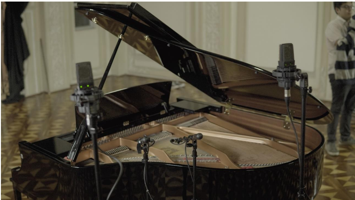
Imagen 8: Configuración de micrófonos para la grabación del piano, MZ14 – Guayaquil 2021. Foto tomada por Daniel Jara Martus.
