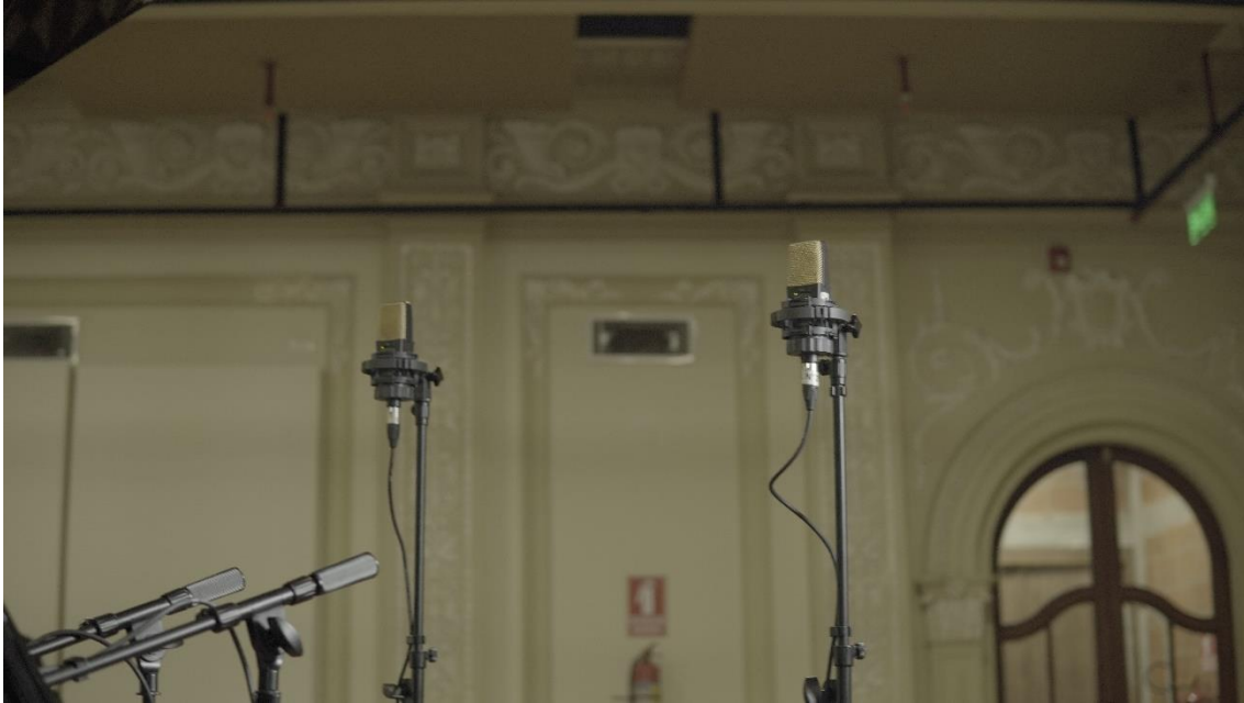
Imagen 7: Microfonía estéreo, técnica AB. Foto tomada por Daniel Jara Martus.
