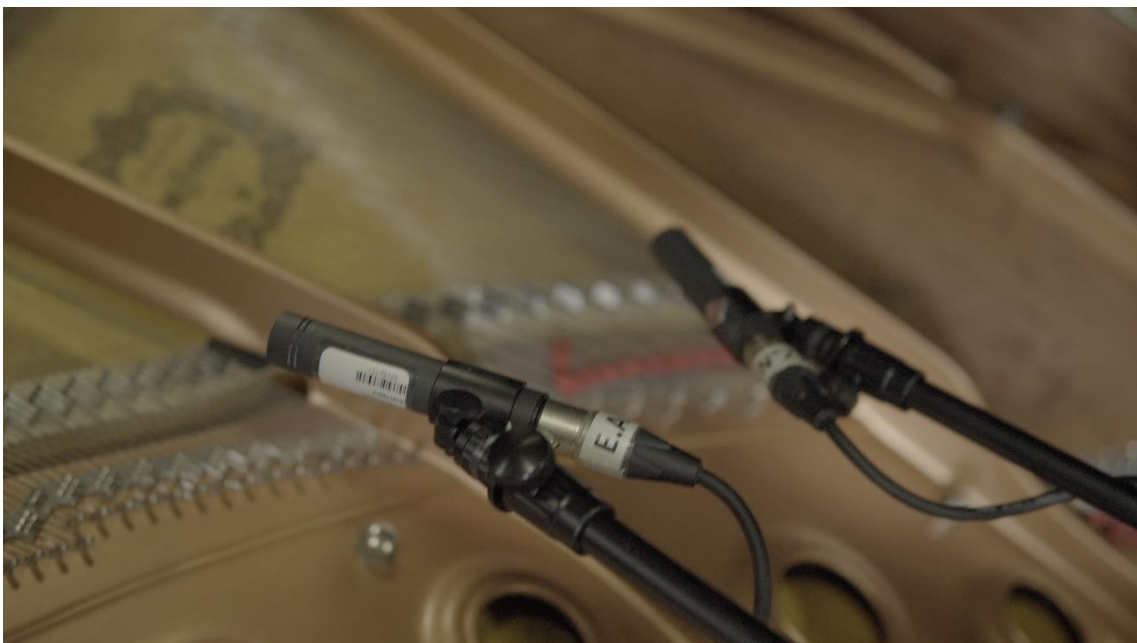
Imagen 6: Microfonía estéreo, par híbrido. Foto tomada por Daniel Jara Martrus.
