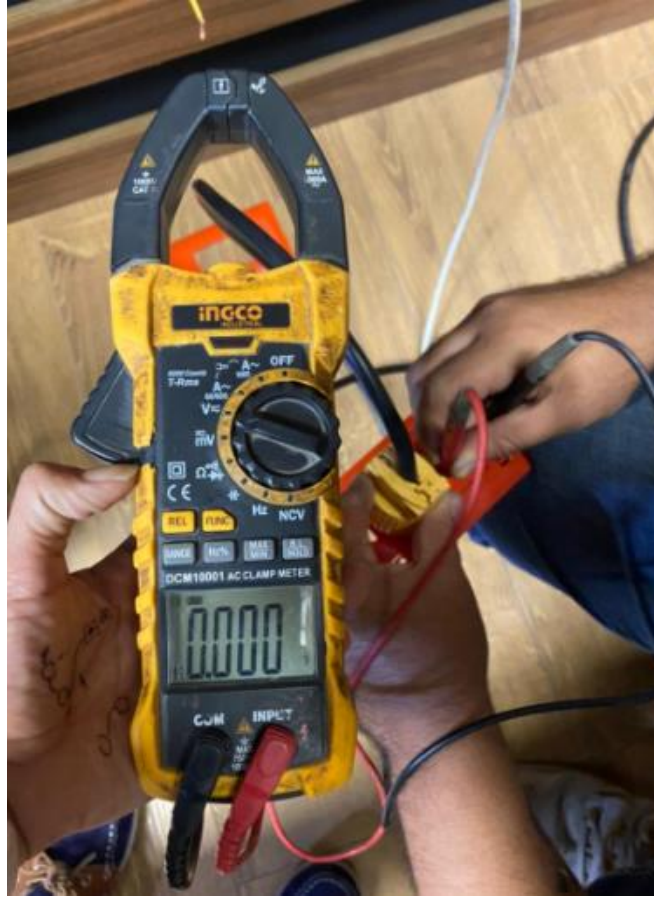
Ilustración 60 Voltaje neutro tierra 0V
