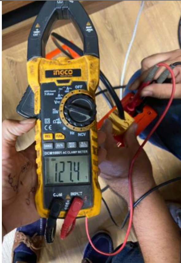
Ilustración 58 Voltaje en tomacorriente
