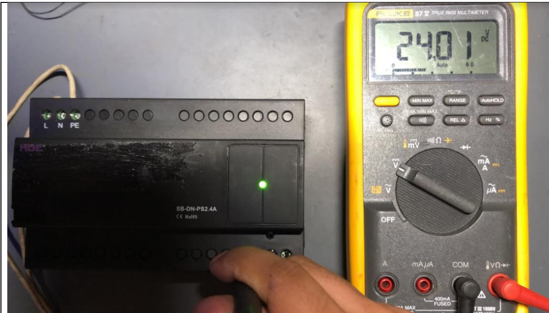
Ilustración 9 Voltaje de Salida de 24 VDC
